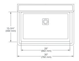
THE OAK HILL LAVATORY CANNOT BE INSTALLED AS A WALL HUNG LAVATORY. THE LAVATORY MUST BE INSTALLED USING THE OAK HILL CONSOLE STAND.
